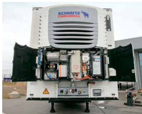
Umweltfreundlich: Die Kältemaschine S.CU ep85 wurde für den Verteilerverkehr konzipiert und ist in einer Mono- und einer MultiTemp-Variante verfügbar.
