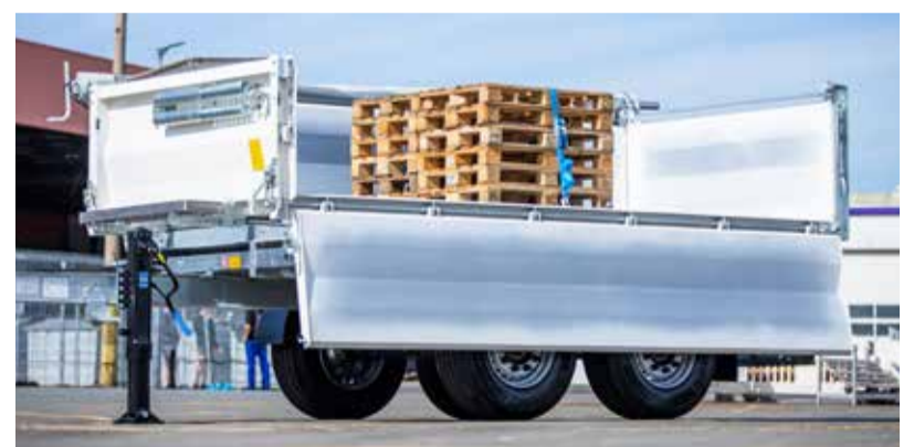
Dank Zurrpunkten im Muldenboden ist der Z.KI auch für den Transport von Palettenware geeignet.
