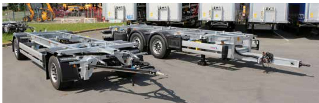
Die Wechselfahrgestelle A.WF und Z.WF sind für 20' Container geeignet.
